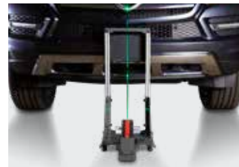
Einfache Einstellung zur Symmetrieachse
