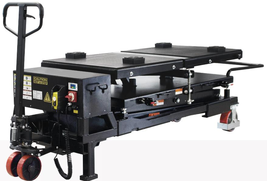
Der hydraulische mobile Hubtisch BT1800 ist für Batterien von Elektrofahrzeugen sowie Motor, Getriebe, Antriebsachse, Kraftstofftank, Aufhängung und Fahrwerkskomponenten von herkömmlichen Fahrzeugen ausgelegt.
