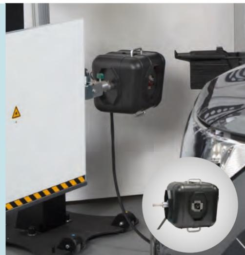
Con il VAS 701 001, la posizione del VAS 6430 è monitorata costantemente durante la calibrazione/regolazione degli ADAS. Le modificazioni nell'asse di marcia o nelle distanze del VAS 6430 rispetto al veicolo vengono immediatamente visualizzate all'operatore (con segnalazione visiva e acustica)
