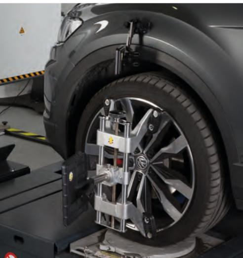
Per la regolazione/calibrazione dei sistemi di assistenza alla guida, è necessaria solo una telecamera aggiuntiva sul VAS 6430 (telecamera di controllo), che può essere usata a sinistra o a destra rispetto alla direzione di marcia del veicolo: la procedura di misurazione è più rapida, si incrementa quindi il numero di veicoli misurabili ogni giorno dall'operatore.
