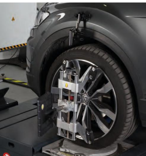
Para el ajuste / calibración de los sistemas de asistencia, solo se necesita una cámara adicional en el VAS 6430 (cámara de control) que se puede usar hacia la izquierda o hacia la derecha en la dirección de desplazamiento del vehículo; el procedimiento de medición es más rápido, el operador puede medir más vehículos al día.
