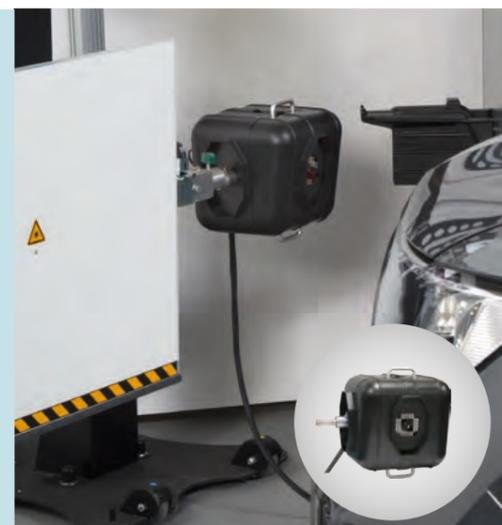
Con el VAS 701 001, la posición del VAS 6430 se monitorea permanentemente durante el calibrado / ajuste del ADAS. El operador recibe inmediatamente (óptica y acústicamente) los cambios en el eje de desplazamiento o las distancias desde el VAS 6430 al vehículo.
